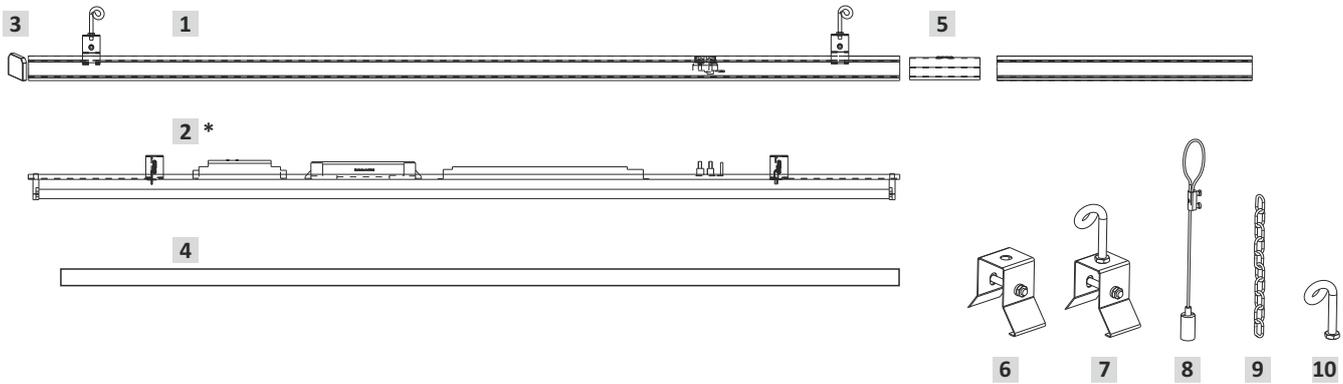
Das Lichtbandsystem wird durch ein Tragprofil, Leuchten, optische Systeme, Deckleisten und Zubehör gebildet.
