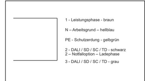
3.2 Schließen Sie den Gessis-Stecker an die Stromversorgung an, ggf. zur Regulierung
