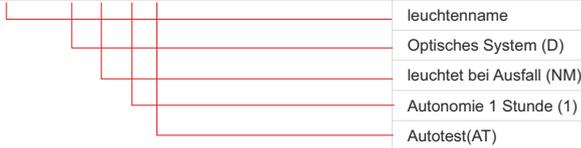
Toleranz der optischen und elektrischen Parameter  $\pm 10\%$ . (M – leuchtet ständig, NM – leuchtet während eines Stromausfalls)
