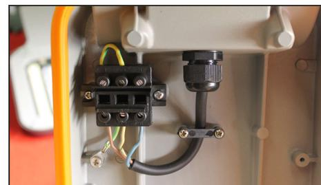
13. Die Kabelverschraubung festziehen.
