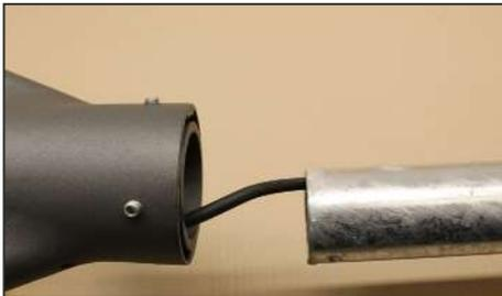
8. Die Leuchte mit 4 Schrauben befestigen. Empfohlener Drehmoment 8Nm.
