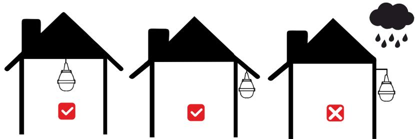
9. Die Leuchte kann mithilfe der Montagebügel installiert werden:
